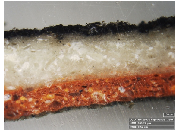
図6 クロスセクションの光学顕微鏡写真
