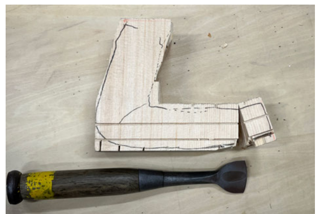
図5 粗彫り時に木材が割れた様子
